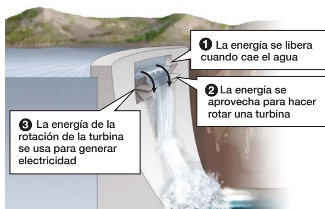
▲ FIGURA 7-8 La energía acumulada en un “gradiente” de agua puede usarse para generar electricidad
